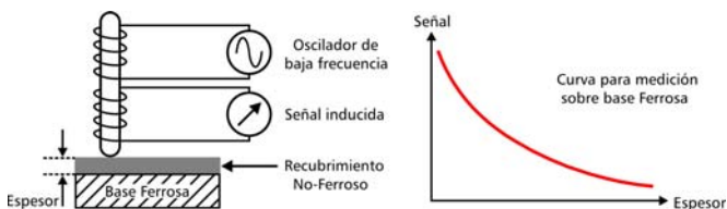
Figura 1: Esquema y curva de respuesta en base ferrosa
